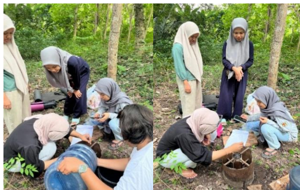
Gambar 2. Mengukur laju Infiltrasi Pada lahan Sekunder
