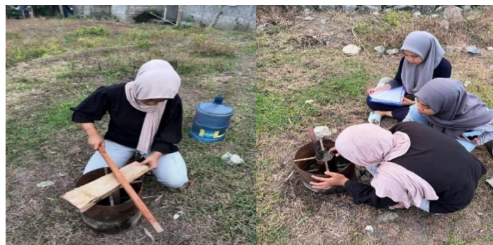
Gambar 6. Mengukur Laju Infiltrasi Pada Lahan Tegalan
